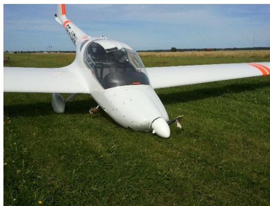
Super-Dimona med avslaget nosställ och skadad propeller.
